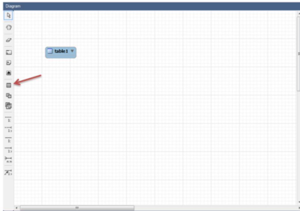
Pour afficher une table il faut cliqué sur l'onglet New Table et ensuite cliqué sur le diagramme. (voir image ci-dessus) Une table1 va alors apparaître.
